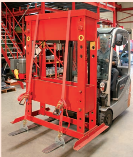
Sécurise les charges avec des pinces à élévateurs et sangles d'arrimage
