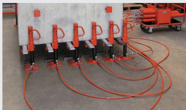
Bloc de pression spécial pour le levage synchrone avec 12 appareils de levage. Klantspecifiek doseersysteem voor het heffen met 12 machineheffers.
